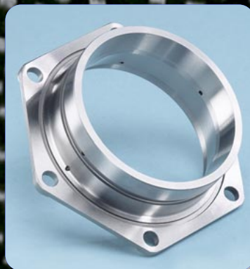
Geflanschte Doppelschale zur Aufnahme zweier Kegelrollen-Konusse, mit Ölnut und Öllochern.
