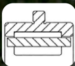
Geflanshtes Duplex-Kugellager für die Axiallastaufnahme in beiden Richtungen. Axialspiel/Vorspannung nach Kundenanforderungen.
